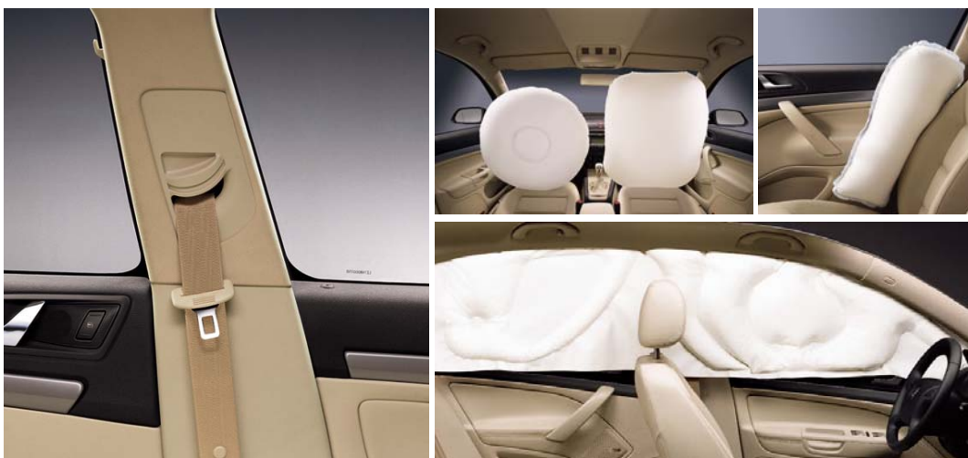
Příklady prvků pasivní bezpečnosti u vozu Octavia: Bezpečnostní pásy, airbagy řidiče a spolujezdce, boční a hlavový airbag
